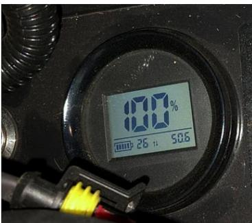
Они показывают зарядку аккумулятора в процентах, напряжение аккумулятора (со стрелками вверх/вниз) и наработку в м/ч. Причем, наработка самого аккумулятора и штабелера на индикаторах будет всегда разная.
