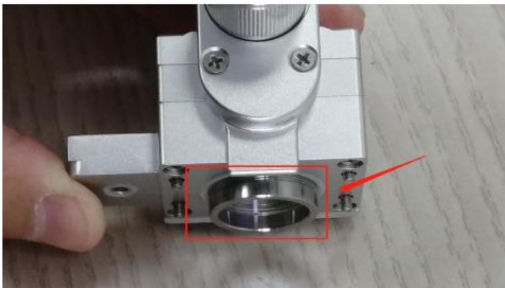
④ При установке линзы обратите внимание на направление установки линзы, плоскость обращена к светоприемной стороне;
