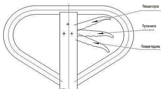
**Внимание!** Скорость опускания регулируется. Можно настроить скорость опускания в зависимости от веса груза: чем больше величина усилия, тем быстрее скорость снижения и наоборот. Скорость опускания груза медленная.
