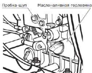
Рис. 2 Заполнение масляного картера
