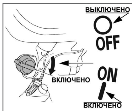
Рис. 12 Выключатель зажигания в положении «Включено»
