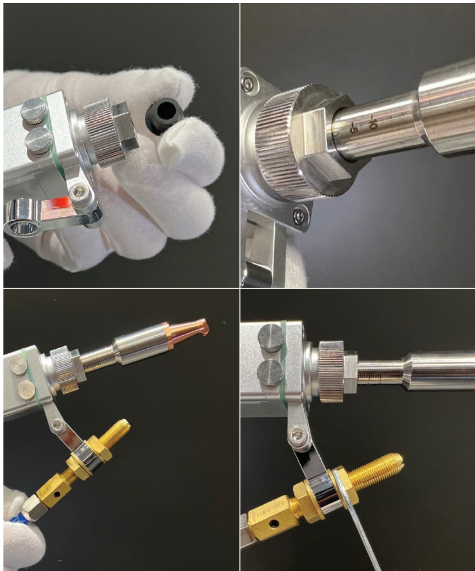
Фото 9.0.11. Сборка сварочной головки.
