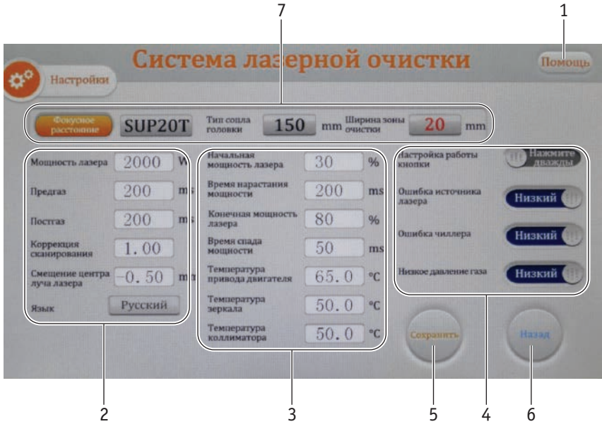
Фото 14.0.5. Главные настройки источника с фокусирующей линзой F150.
