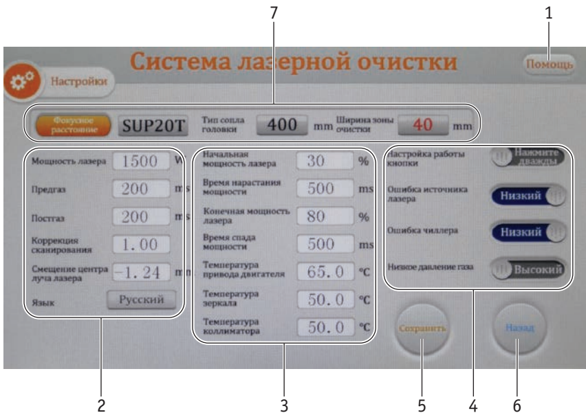
Фото 14.0.6. Главные настройки источника с фокусирующей линзой F400.
