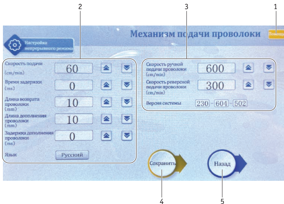
Фото 7.1.2. Интерфейс настроек стандартного режима.
