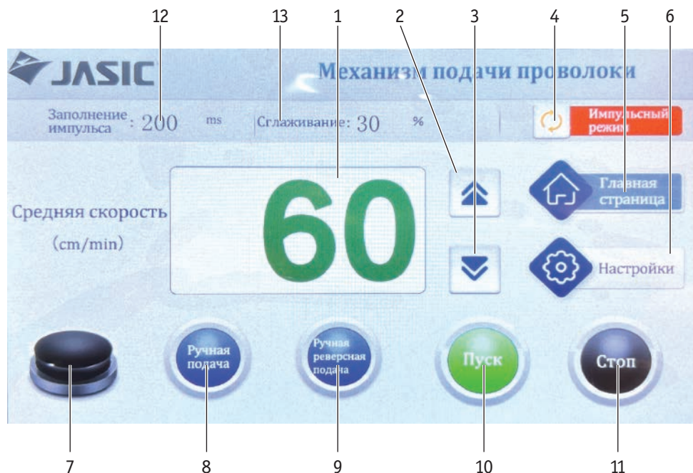
Фото 7.1.4. Интерфейс настроек импульсного режима.
