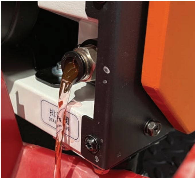
Фото 9.0.4. Слив охлаждающей жидкости.
