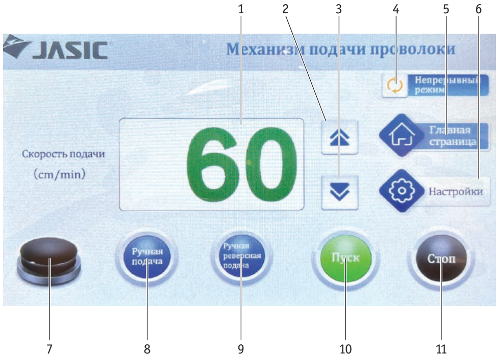
Фото 7.1.1. Интерфейс подающего механизма в стандартном режиме работы.
