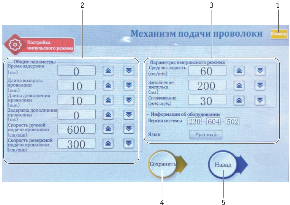
Фото 7.1.5. Интерфейс настроек импульсного режима.
