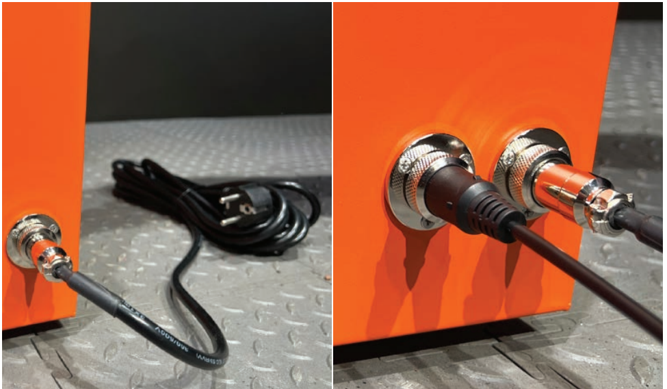
Фото 9.0.7. Подключение кабеля питания и связи.
