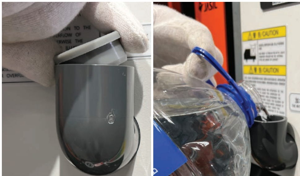
Фото 9.0.3. Заливание охлаждающей жидкости.
