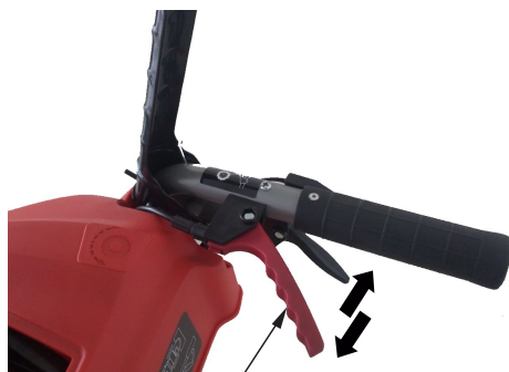
РЫЧАГ РЕГУЛИРОВКИ ВЫСОТЫ КОРПУСА ШНЕКА
