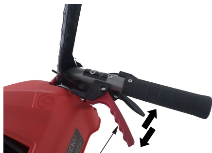
РЫЧАГ РЕГУЛИРОВКИ ВЫСОТЫ КОРПУСА ШНЕКА
