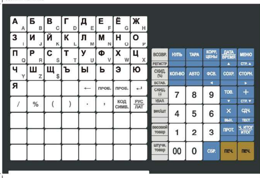
Рисунок 1.8 – Вид клавиатуры весов подвесной модификации
