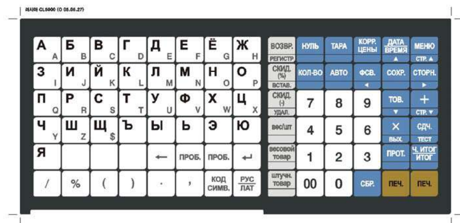
Рисунок 1.6 – Вид клавиатуры весов модификации без стойки
