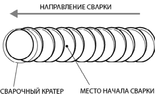
Рис. 13.5. Начало сварки при смене электрода.
