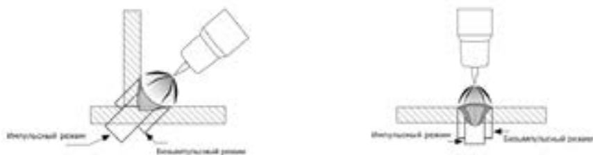
Рис. 8.7. Выделяемое тепло в импульсном и безимпульсном режимах.
