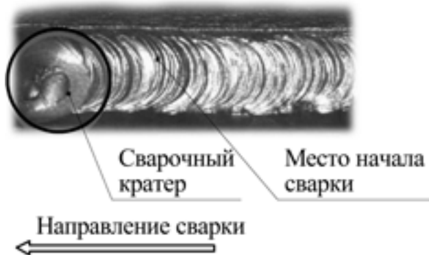
Рис. 9.4. Начало сварки при смене электрода.
